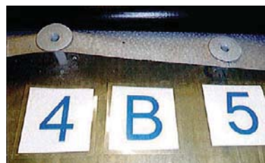
Wyrwanie łącznika z podłoża
