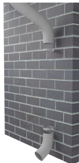
Rozplanowanie obejm rury spustowej
