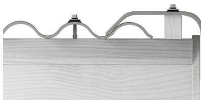
rys.40. Montaż wiatrownicy o zagiętym ramieniu.
